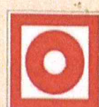
Кнопка включения установок (систем) пожарной автоматики
